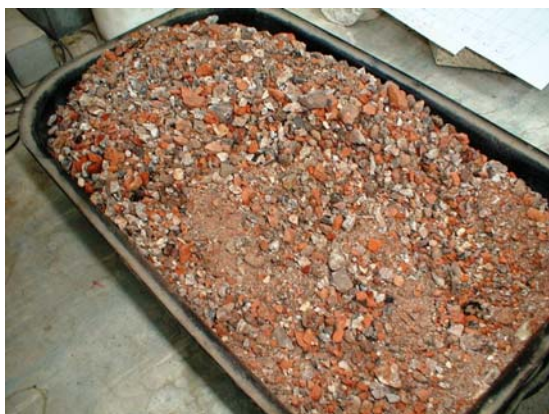
Obr. 3 Nečistá cihelná drť frakce 8/32 rozdrobená v recyklačním středisku
