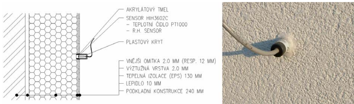
Obr. 3 Znázornění měření vlhkosti v ETICS
