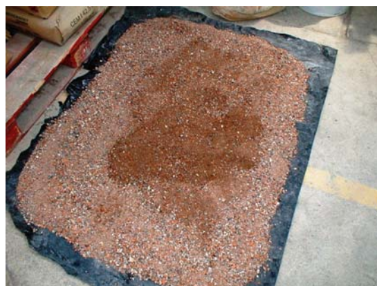
Obr. 4 Nečistá cihelná drť předrcená v laboratorní drtičce na frakci 0/8
