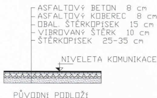
Obr. 3 Uvažovaná skladba profilu komunikace II/261.
