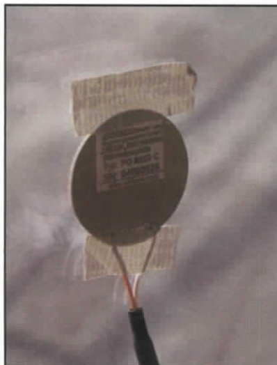
Obr. 7 Čidlo tepelného toku přilepené na skle
