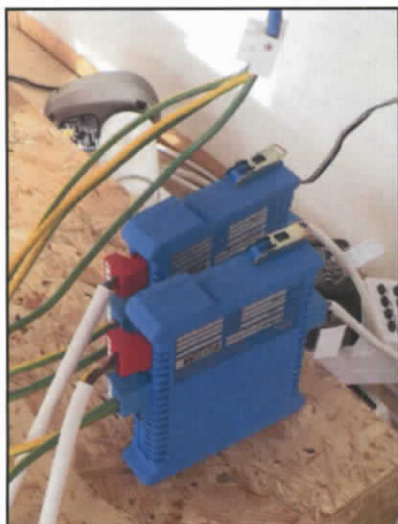
Obr. 5 Převodníky napětí a proudu v fotovoltaickém panelu
