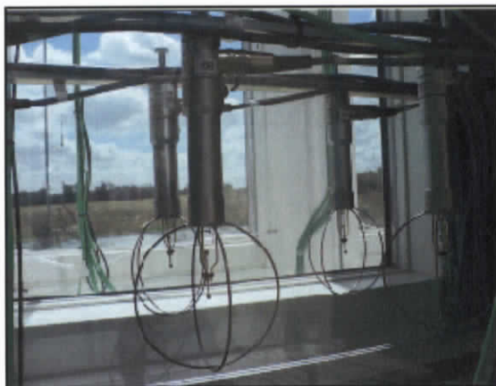
Obr. 11 Rychlostní senzory na vstupu do sol. komína
