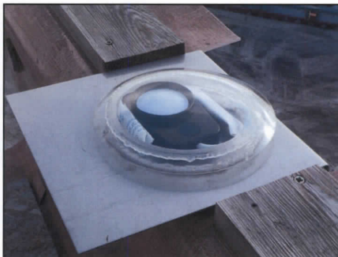
Obr. 7 Čidlo tepelného toku přilepené na skle
