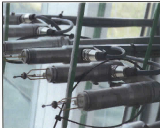
Obr. 12 Rychlostní senzory pro měření horizontálního rychlost. profilu
