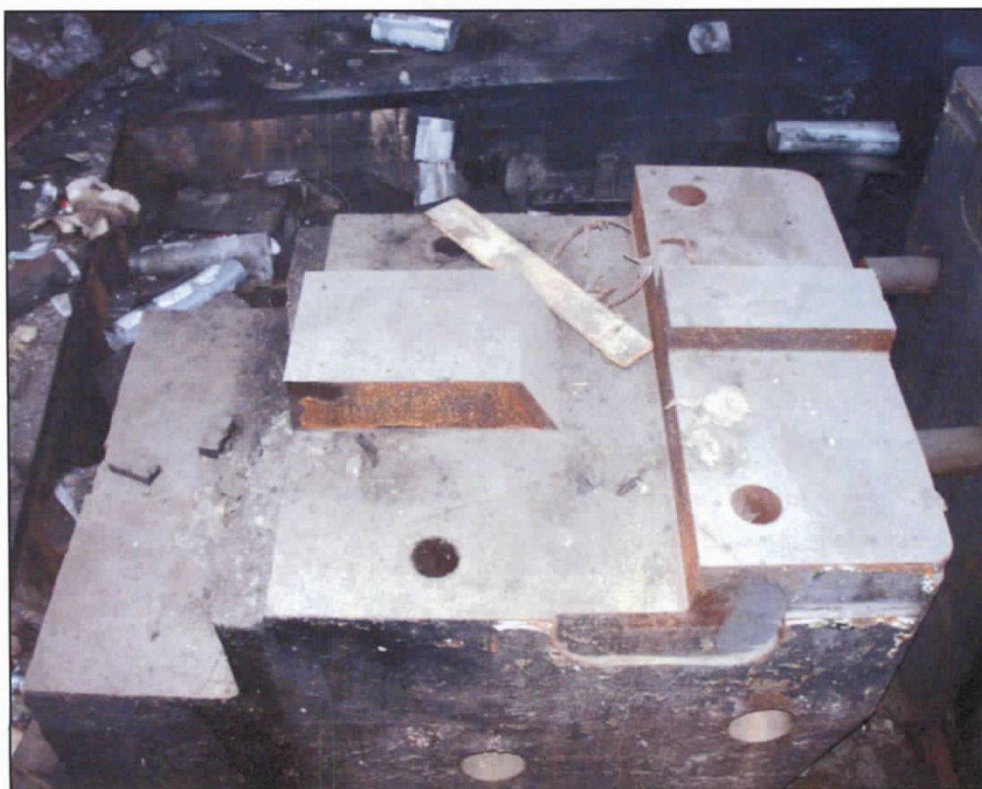
obr. 4: Příklad ocelolitinového podkladního bloku určeného k destrukci
