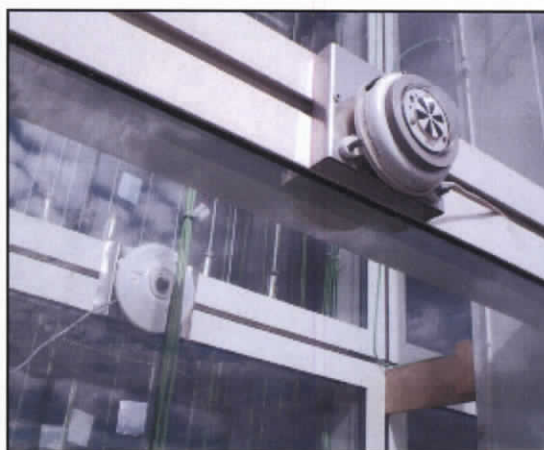
Obr. 14 Pyranometry na DF, Wilhelm Lambrecht napravo a CM11 nalevo
