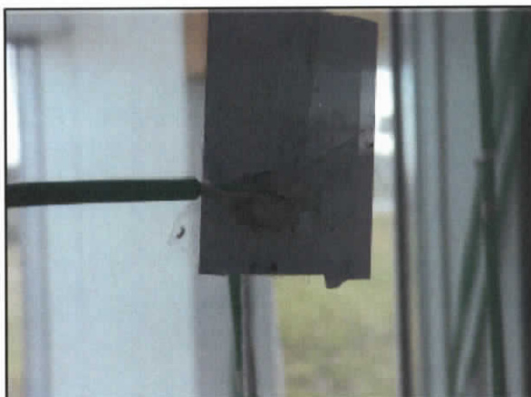
Obr. 10 Měření povrchové teploty skleněných tabulí
