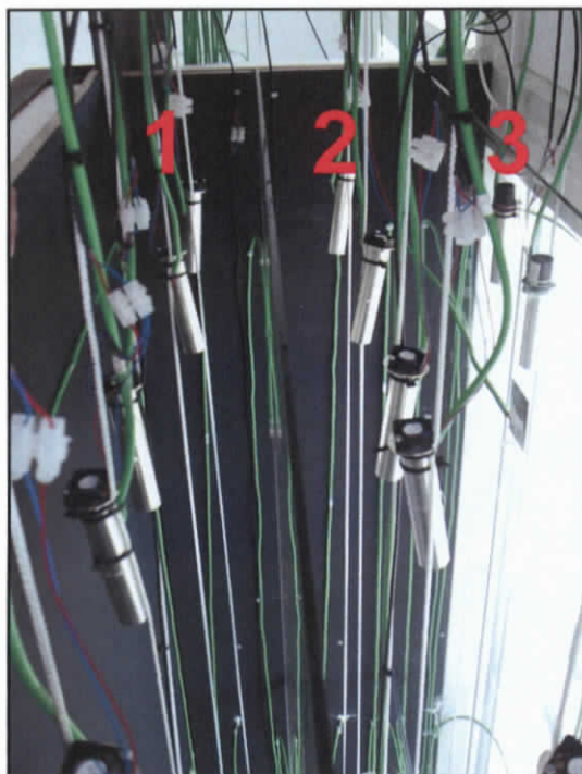
Obr. 5 Multisolární komín se třemi dutinami
