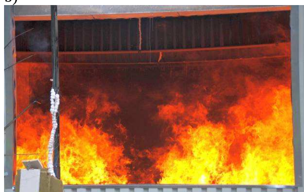
Obr. 1 a) Umístění nosníků s tvarovanou stojinou ve stropu experimentální budovy, b) Pohled do okenního otvoru požárního úseku ve 47. min zkoušky
