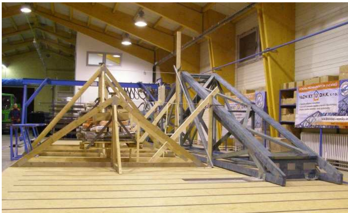
Obr. 2 - Zatěžovací zkouška ZP1 - maximální zatížení 1320 kg
