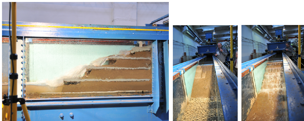
Obr. 2 Laboratorní model hráze s vloženými vláknobetonovými deskami
