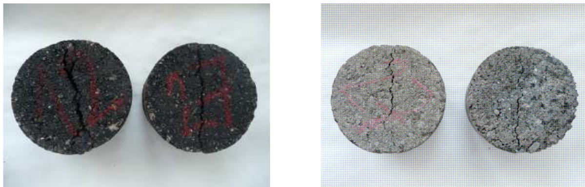
Obr. 5 Tělesa po zkoušce pevnosti v příčném tahu po 7 dnech F1 a F4
