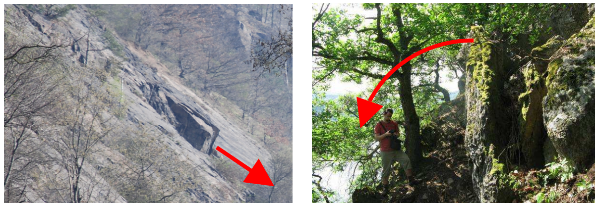
Obr. 5: Blok s předpokládaným a)translačním pohybem, b) rotačním pohybem
