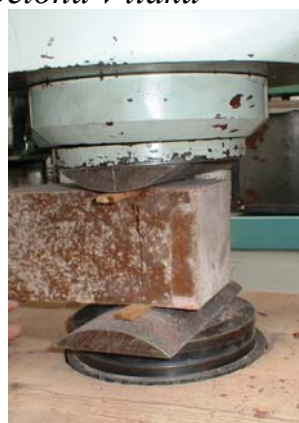
Obr. 3 Zkouška pevnosti cihlo- betonu v tlaku
