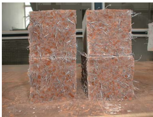
Obr. 9 Homogenita těles z vláknocihlobetonu
