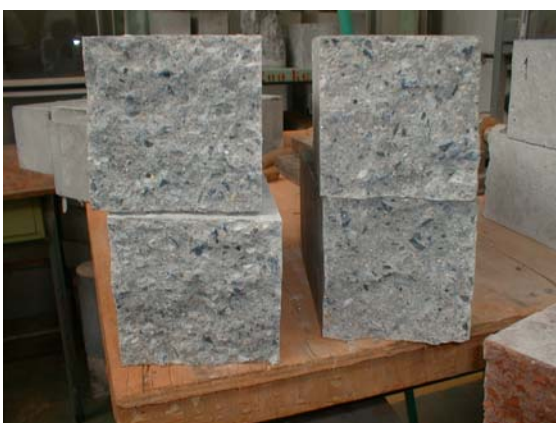
Obr. 4 Zkouška vláknocihlobetonu v tahu za ohybu
