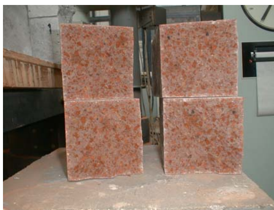
Obr. 5 Zkouška cihlobetonu v příčném tahu
