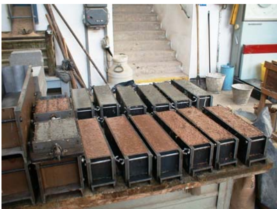
Obr. 2 Vyrobená tělesa z písko- betonu a cihlobetonu
