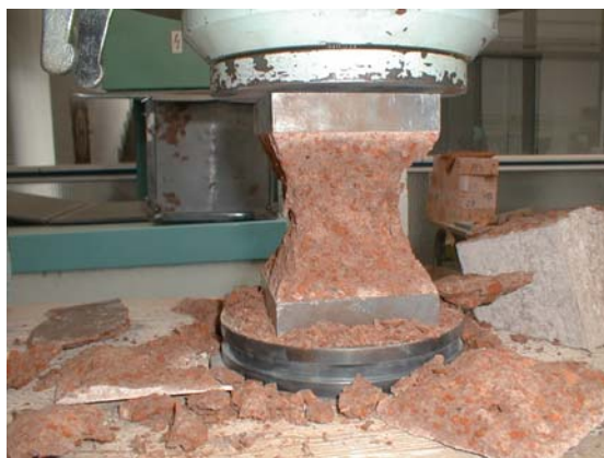
Obr. 3 Zkouška pevnosti cihlo- betonu v tlaku
