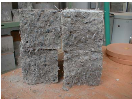
Obr. 8 Homogenita těles z vláknopískobetonu
