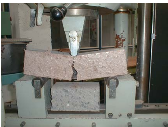
Obr. 4 Zkouška vláknocihlobetonu v tahu za ohybu
